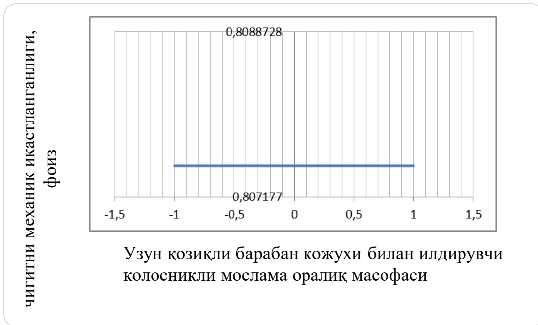
1-расм. Пахта тозалагичининг тозалаш вақтида чигитни механик шикастланишига узун қозикли барабан кожухи билан илдирувчи колосникли мослама оралик масофасини таъсири
