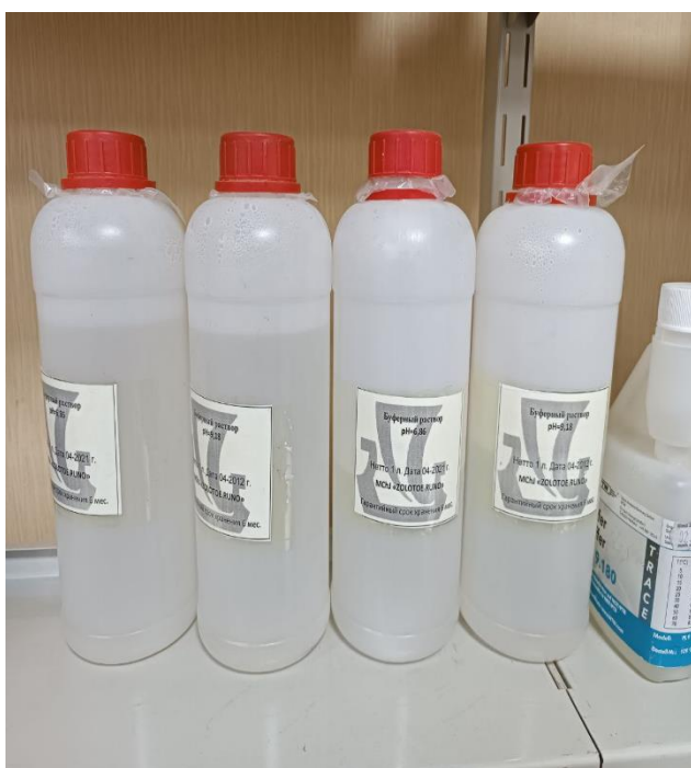
3-расм. рН-метрларни калибрлашда ва метрологик текширувларда қўлланиладиган буфет эритмалар
