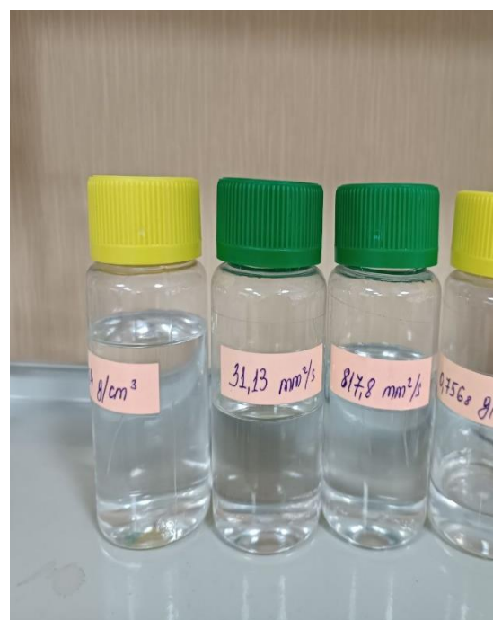
4-расм. Визкозиметрларни метрологик хоссаларини тадқиқ қилишда фойдаланиладиган ишчи стандарт намуналар (метрологик кузатувчанлик таъминланган)
