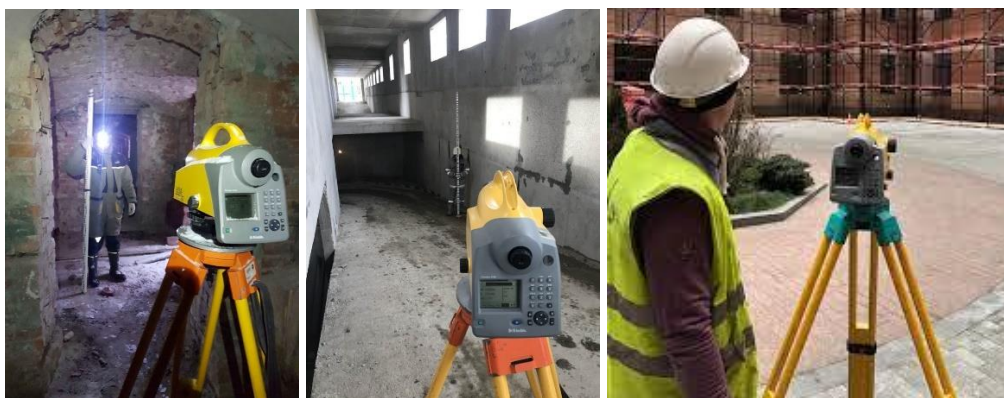
4-чизма. Бино ва иншоотнинг деформациясини кузатишда қўлланиладиган рақамли нивелирлар
